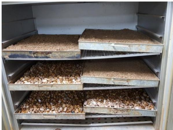
**Figura 1** - Secagem de agregados em estufa.
