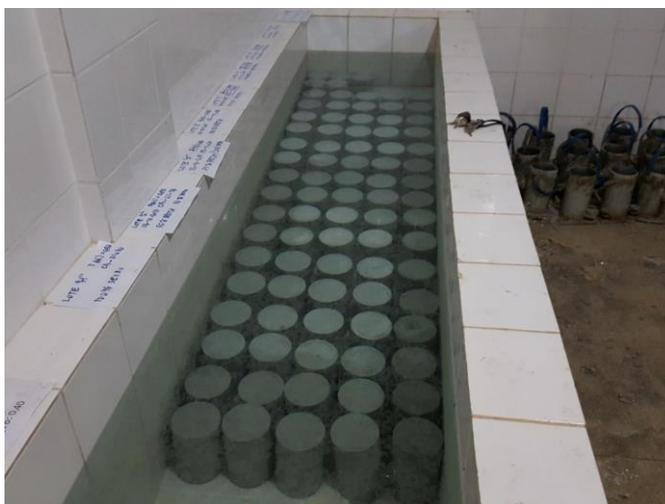
**Figura 3** - Cura dos corpos de prova imersos em água com cal.
