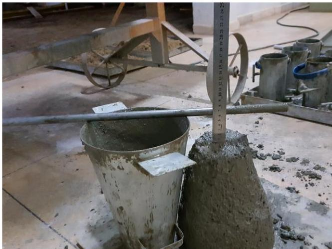
**Figura 2** – Ensaio *Slump test* do lote E (60 mm).
